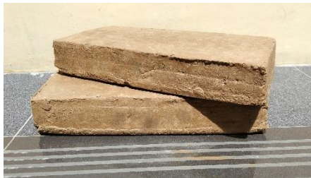
Gambar 4.2.2 Pencetakan BEKON® dengan ukuran 24x12x6
