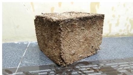
Gambar 4.2.3 Pencetakan BEKON® dengan ukuran 15x15x15
