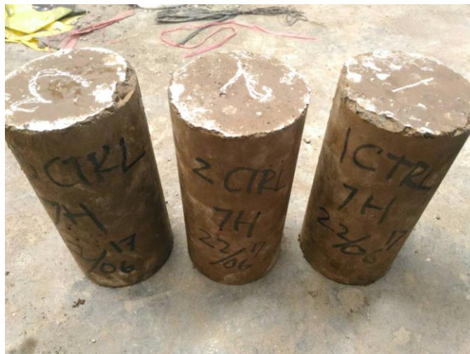
Perawatan Benda Uji Dengan Paparan Udara Bebas
