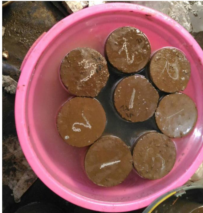
Perawatan Benda uji ke dalam air laut (ASTM D1141-98)
