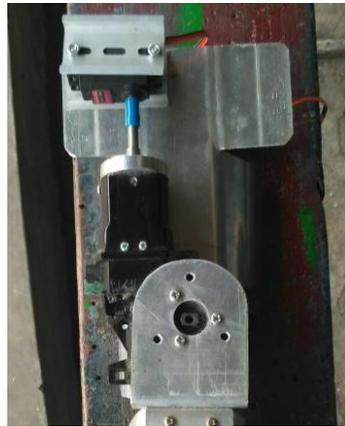
Gambar 2.2 Motor Servo dan motor motor power window
